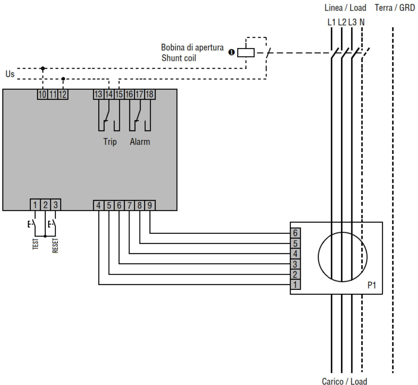
● Il collegamento della bobina può variare in funzione del tipo di apparecchio collegato (contattore, interruttore con bobina di apertura oppure con bobina di minima tensione).
